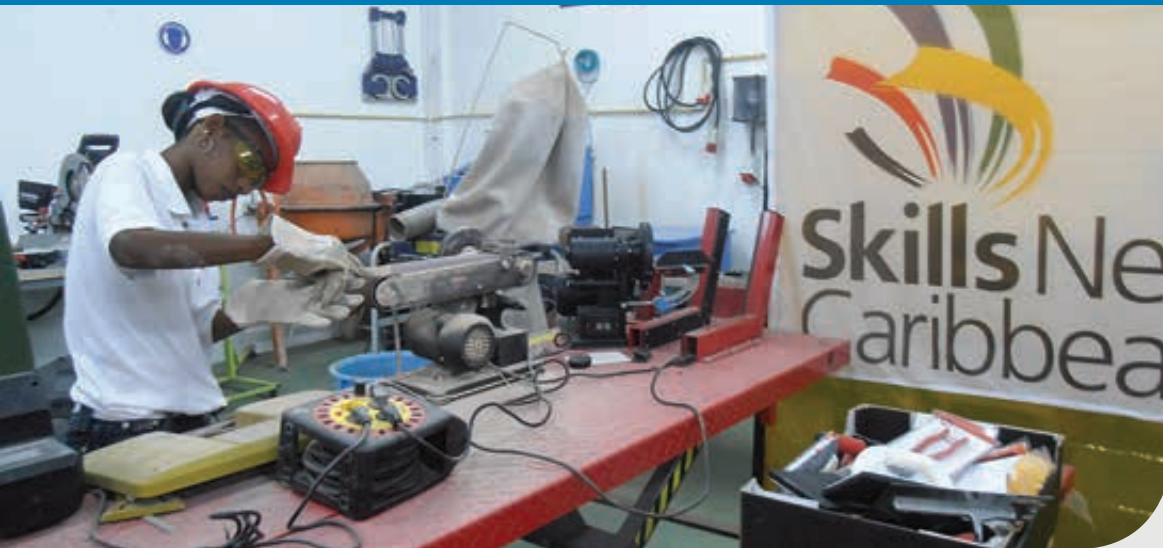
Studente Daniëlle slijpt een stukje tegel af, voor de opdracht "wall tiling".
